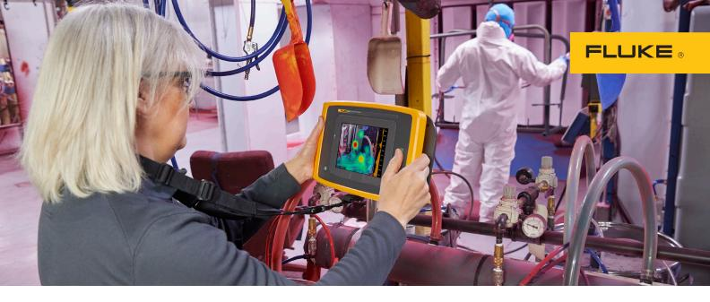
Bei Ultraschallmessgeräten werden Mikrofone verwendet, um Geräusche im Zusammenhang mit entweichender Luft bzw. entweichendem Gas in einem Bereich von ca. 38 kHz bis 42 kHz zu erkennen. Sie wandeln in diesem Bereich erfasste Geräusche in hörbare Geräusche um, die Lecksuche ist also weiterhin abhängig vom menschlichen Gehör. Das macht die Erkennung subjektiv und erfordert spezielle Kompetenzen und Schulungen.
